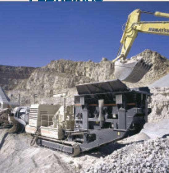
Uma linha completa de trituradoras móveis Lokotrack, da Metso.
