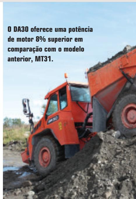
(em condições normais de trabalho), e também possui oito marchas para frente e quatro para trás. A transmissão totalmente automática e o câmbio Tiptronic (conta com versões de câmbio automático e manual) permitem ao operador uma melhor concentração nas condições de trabalho e melhora a transferência da potência do motor às rodas.
