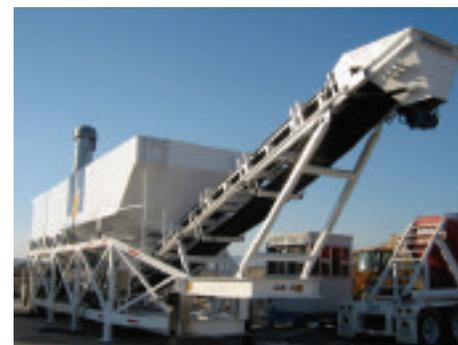
equipamento facilitando a mobilização e desmobilização da Central. O equipamento vem completamente montado da fábrica e pré cabeado. A usina pode ser instalada sem uma fundação especial e sua montagem ou desmontagem dura apenas um dia.
