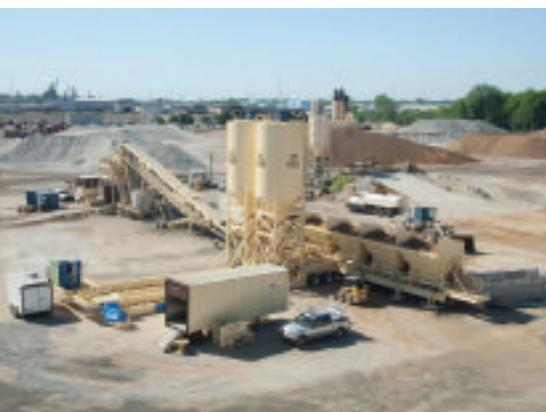
**O equipamento da Astec oferece uma "mistura contínua" que permite proporcionar material em três tremonhas.**
